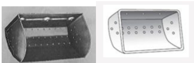
Figura 4.11. Vasos de elevador de cangilones ventilados para mejorar la absorción y descarga del producto en un elevador de cangilones.
