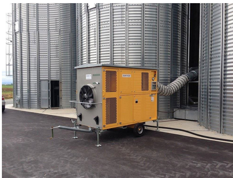
Figura 4.16. Sistema de aireación de grano refrigerado conectado al conducto de aireación de un individuo o conjunto de silos de acero. La unidad móvil se puede mover de un silo a otro, así como a lo largo de un almacén y conectarse a Conductos de aireación para enfriar y mantener la calidad del grano almacenado independientemente de las condiciones climáticas ambientales.
