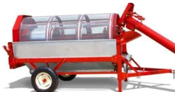
Figura 4.3. Limpiador giratorio estilo tambor que permite cribado y separación.
